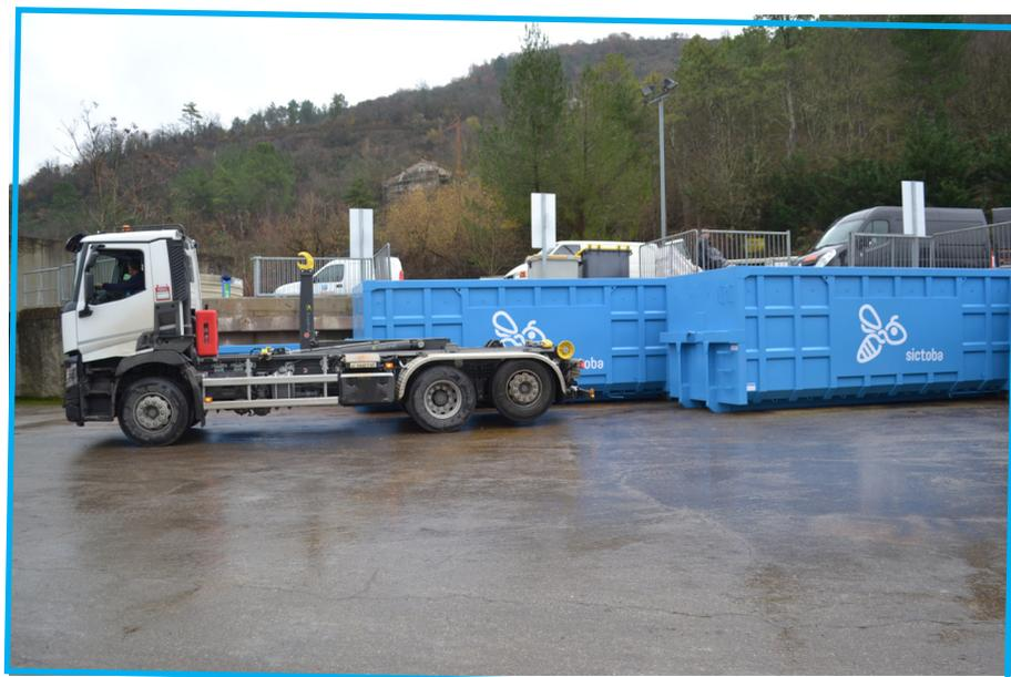
Le camion Ampliroll permettant de transporter les bennes de déchetteries
