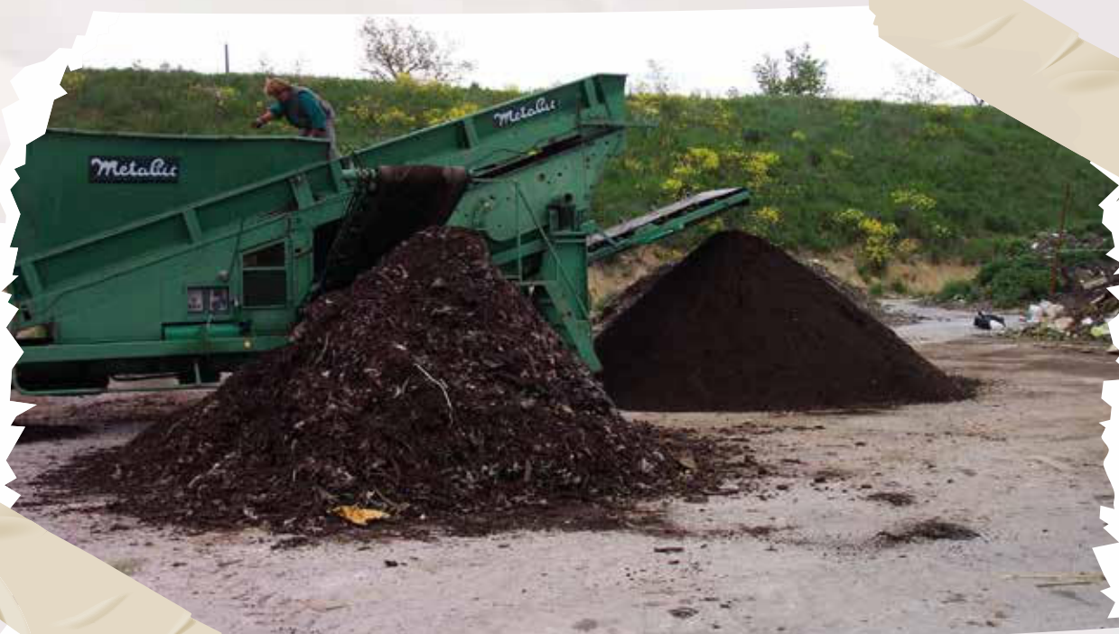
Criblage du compost sur la plateforme de Barjac
